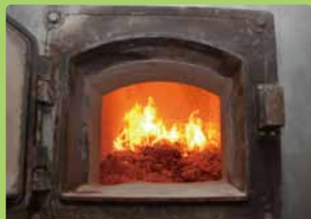
焼却炉に運ばれたごみは850度以上の高温で焼却され、排ガスと灰に分かれます。
